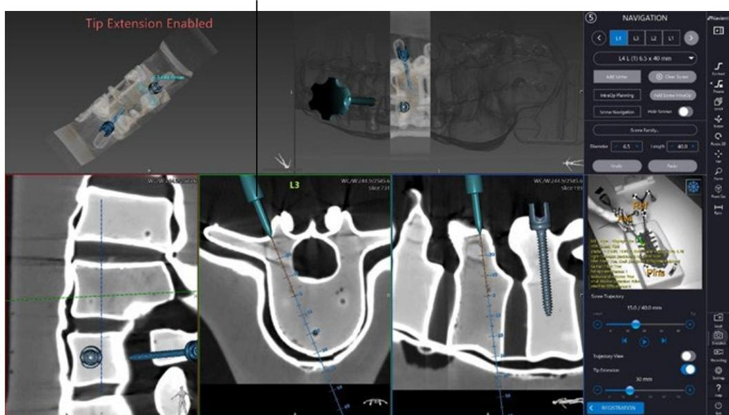
Si el plano incluye tornillos y la punta del instrumento se acerca a un tornillo, la ventana gráfica en 2D más a la derecha mostrará la guía de navegación. El color de la guía cambiará de verde a amarillo y rojo a medida que la punta se acerca y penetra más allá de la
