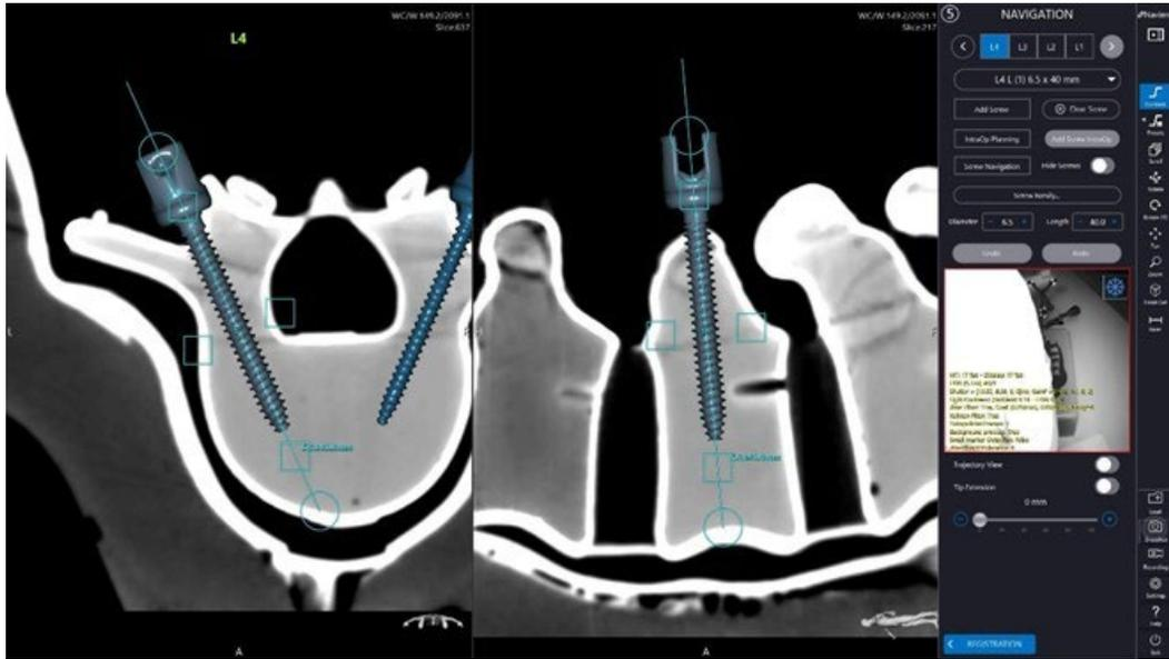
En la etapa Navegación, las ventanas gráficas muestran una representación virtual del eje del puntero cuando la cámara detecta cualquier instrumento rastreado dentro de las proximidades de la pila de cortes.
